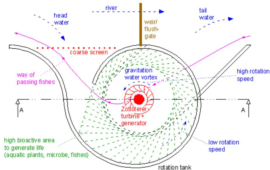
Das Gravitationswasserwirbelkraftwerk (GWVPP) ist eine neue Form eines Bio-Reaktors, welcher gewässerspezifische Wasserpflanzen, Kleinlebewesen und Fische generiert. Der Gravitationswasserwirbel im Rotationsbecken bildet eine Wasser belüftende Zone samt Zotlöterer-Turbine in seinem Zentrum und eine hoch bioaktive Zone im Außenbereich.
