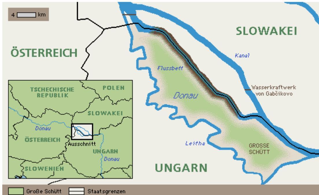
Südöstlich von Čunovo, bei Stromkilometer 1.853 zweigt der 38,5 km lange Kraftwerkskanal ab und mündet bei Donau-km 1.811 wieder in das ursprüngliche Flussbett. Rund 80 % des Wassers der Donau werden in diesen Kanal umgeleitet, der parallel zum alten Donauebett läuft und bis zu 700 m breit ist.
